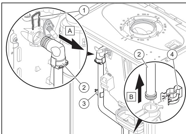
4. Снимите датчик температуры (3).
