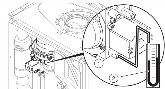
3. Подключите манометр (2) к измерительному штуцеру (1).
