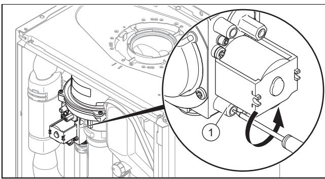
2. С помощью отвертки выкрутите уплотнительный винт на ниппеле для проведения измерений (1) газовой арматуры.
