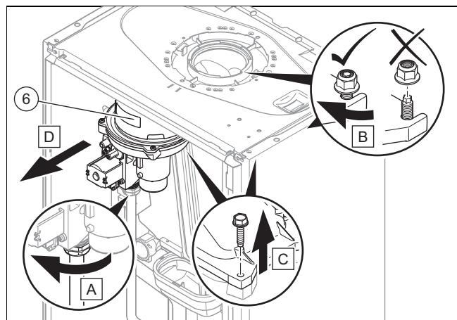
9. Снимите газовоздушный тракт (6).
