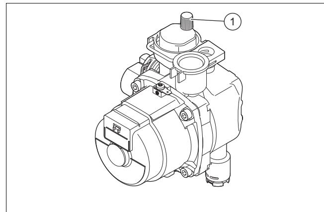
1. Снимите колпачок вентиля для выпуска воздуха (1) на насосе, а также на быстродействующих воздуховодчиках.
