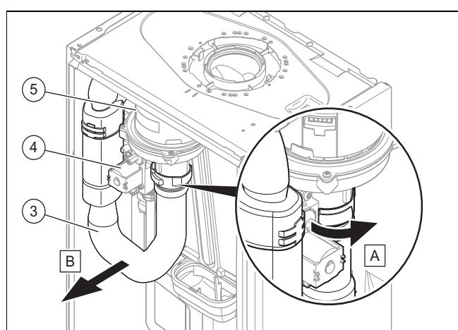
7. Снимите воздухозаборную трубу (3).
