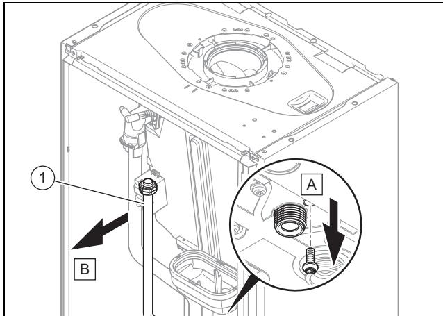
3. Снимите газовую трубу (1).
